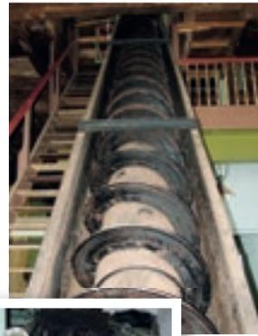
In der Rübenwäsche-Anlage mit großem Hubrad wurden die Zuckerrüben von Schmutz befreit. Die gereinigten Zuckerrüben förderte eine 17 Meter lange Transportschnecke über eine Rübenkipplwaage in die Schneidmaschinen, wo sie zu Schnitzeln zerkleinert wurden.
