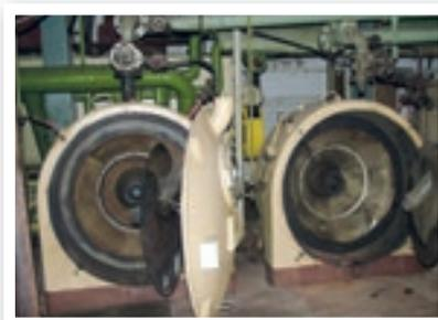
In den Zentrifugen wurden die Zuckerkrystalle vom anhaftenden Sirup getrennt. In den 70er-Jahren testete die Zuckerfabrik Oldisleben für diesen Prozess auch Sonderkonstruktionen.
